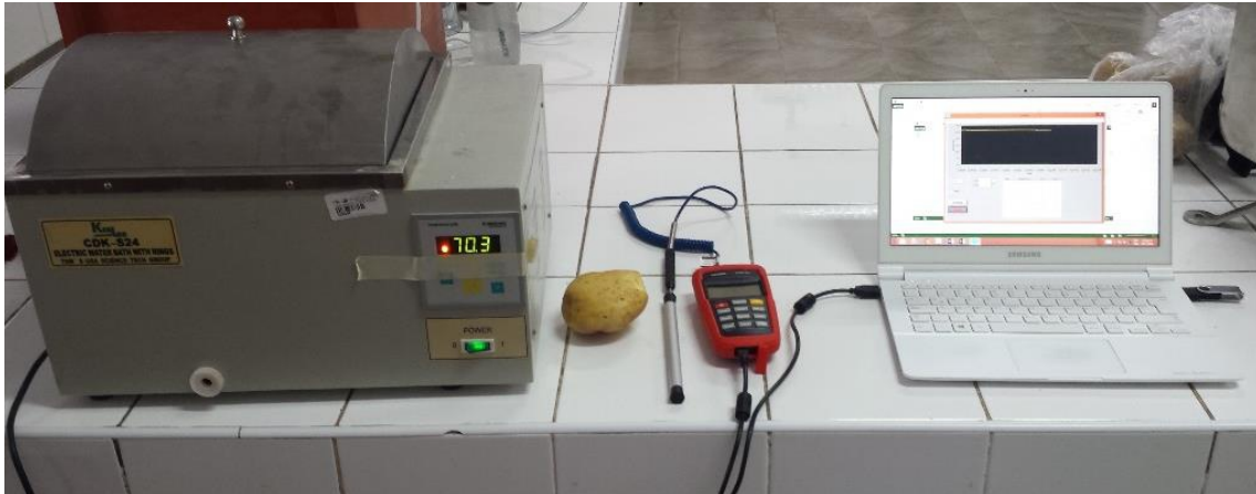
Figura 1. Sistema de calentamiento y adquisición de datos
